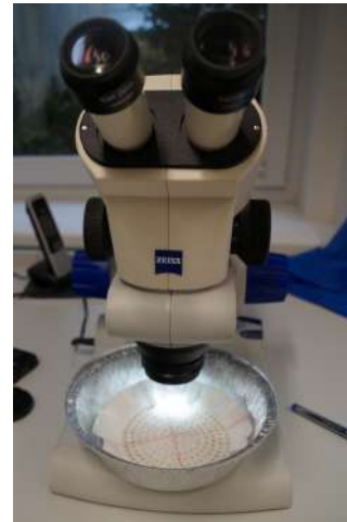
Abb. 9: Visuelle Bestimmung unter ZEISS; Stemi 508.
